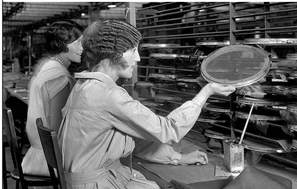
Hangszóró-védőrács szerelése az Atwater Kent rádiógyárban, 1928
